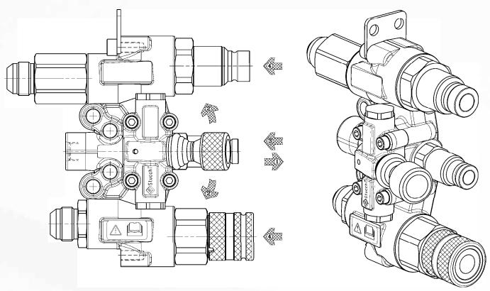
OPERATION N°1 FULL THE LEVER TO UNLOCK THE SECURITY SYSTEM
