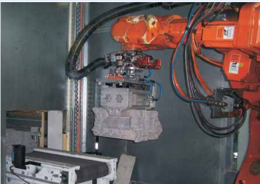
Spannen von Gusswerkstücken Clamping of cast pieces
